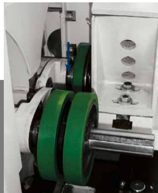
Gruppo d'avanzamento posto dopo l'albero orizzontale superiore
