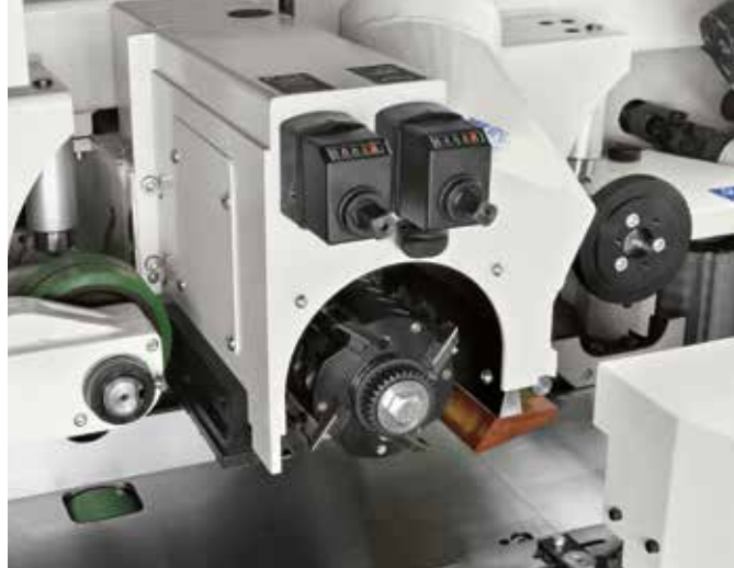
Kit per consentire la profilatura dell'albero orizzontale superiore Comprende n. 2 visualizzatori meccanici con precisione decimale. Diametro min./max. dell'utensile 100/180 mm. Corsa assiale 40 mm.
