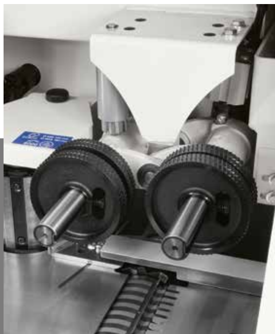
Gruppo d'avanzamento prima dell'albero orizzontale inferiore
